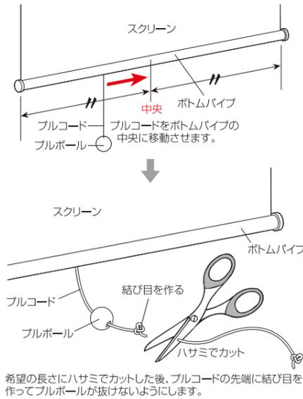
**△注意** プルコードがボトムパイプの中央にない状態や取り付け場所が水平でない状態で昇降を繰り返しますと巻きズレを起こしスクリーンが傷ついたり、破損や故障の原因になる恐れがあります。
