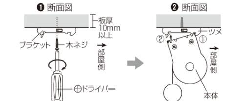
両端のブラケットの止め位置は、本体の両端より約50～80mm内側に、残りのブラケット全ては、両端のブラケットの止め位置の直線上に等間隔になるようにしてください。
