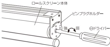
**注意** 巻き上げ強度を調整する場合は、スクリーンを巻き上げた状態で調整してください。また、巻き上げを強くする場合は、あまり回し過ぎますと内蔵されたパネが破損します。1~2回転ごとにスクリーンを昇降させながら行ってください。
