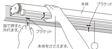
**△注意** 本体の取付後は、取り外す時以外、ブラケットのプラスチックの突起部分には触れないようにしてください。
