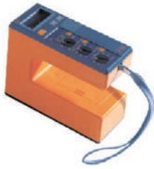
高周波式水分計 (株式会社化学研究所 HI-520) を用いた測定
