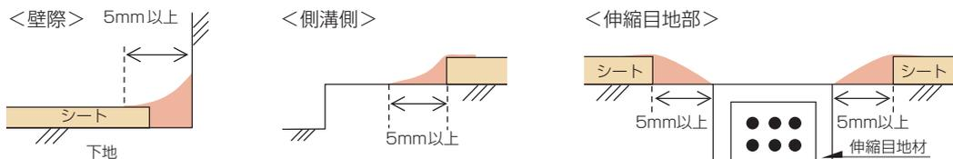
※伸縮目地がある場合は目地手前で端部処理を仕上げ、目地を露出させてください。(伸縮目地上にシールを打設すると、シールにひび割れが発生する恐れがあります。)
