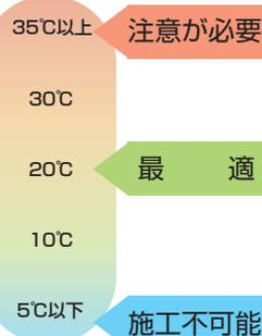
床材が柔らかくなり蛇行したりシワが発生しやすくなります。エポキシ系接着剤は主剤と硬化剤を混合すると硬化しますので使用する分だけ混合してください。接着剤の**オープンタイム・張り付け可能時間は短くなる**のでスピーディに作業してください。
