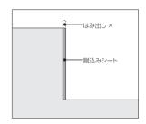
下図のように東リNSステップ800折曲げ部 を階段の曲がり部分にあてがい、折曲げ部に 空洞が生じないように注意して貼付けます。
