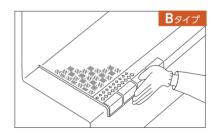
蹴込み面の貼付けは、コーナーローラーなど で折りグセを付けて納めます。
