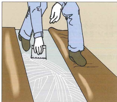
●ゴム系シートの施工に
