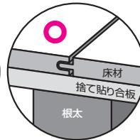
捨て貼り合板の継ぎ目と床材の継ぎ目が重ならないようにしてください。
