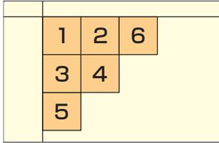
コルクタイルは先に引いた基準線が交差する所から貼り始めます。その際、片寄って力を加えようと目地に狂いが生じますので均一に力を加え、すき間が生じないように注意してください。
