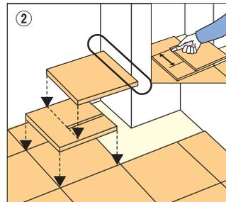
反対側の、すでに敷きこんであるコルクタイルの上に、先程カットしたコルクタイルを重ねます。さらに定規用のコルクタイルを重ね、一边を壁にぴったり合わせて出隅コーナー部分と平行な位置までカッターナイフでカットします。
