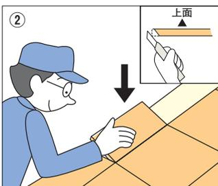
できあがったコルクタイルの壁に当たる面を斜めにカットし、壁際に敷き込みます。仕上げにハンドローラーで押さえます。
