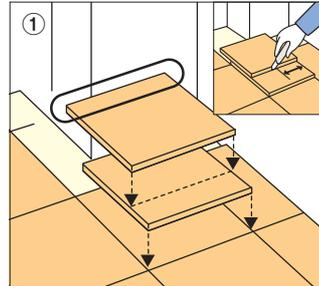
すでに敷きこんであるコルクタイルの上に、カットするコルクタイルを重ねます。さらに定規用のコルクタイルを重ね、一边を壁にぴったり合わせて出隅コーナー部分と平行な位置までカッターナイフでカットします。
