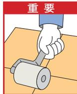
**重要** コルクタイルの接着は1枚づついいねいにローラーで圧着してください。仕上げには、目地の上から全体をハンドローラーで押さえます。
