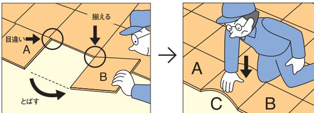
敷き込みの途中で万が一コルクタイルAが目違い(2～3mm程度)が生じた場合は1枚飛ばしてBを正位置に貼り、AB間にCを曲げて押し込むように貼ってください。
