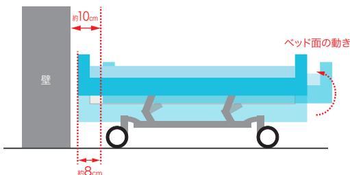
✗ ベッドの高さが中間位置で設置され壁との距離がない場合、昇降時に押し出される動きによって、ロックされたキャスター部分と床面に負荷がかかる。
